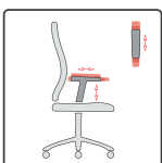
Armstützen, oben-unten, breite und Aufsätze vorn-hinten armrests, up-down, width and covers front-back podłokietniki, górę-dół, na szerokość i nakładki przed-tył
